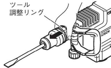
2. ツール調整リング④を回して、先端工具を任意の向きにセットします。
