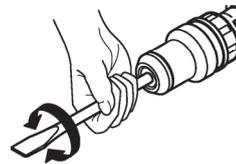
☞ 先端工具の向きは、30度ずつ12段階にセットすることができます。
