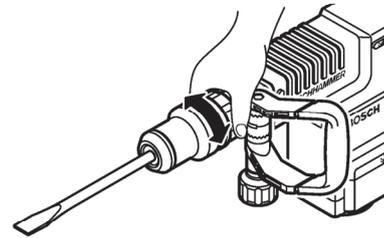
3. ツール調整リング④を離し、先端工具を回してロックされていることを確認してください。
