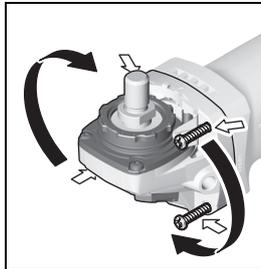
Il est possible de faire pivoter le carter d'engrenage par paliers de 90°. Ceci permet de mettre l'interrupteur Marche/Arrêt dans une position de maniement favorable à des utilisations spécifiques, p. ex. pour des travaux de tronçonnage effectués au moyen du carter d'aspiration avec glissière de guidage **19** ou pour les gauchers.
