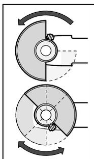
Colocar a cobertura de protecção **7** sobre a gola do veio. Adaptar a posição da cobertura de protecção **7** aos requisitos do processo de trabalho. Travar a cobertura de protecção **7** apertando o parafuso de fixação **20** com a chave combinada **4**.
