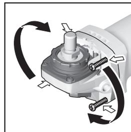
Đầu máy có thể xoay được đối với vỏ máy ở vào 90 ° nấc. Bằng cách này, công tắc Tắt/Mở có thể mang lại vị trí thuận lợi hơn đối với các tình huống gia công đặt biệt, vd., gia công cắt có sử dụng đường cắt có chắn bảo vệ
