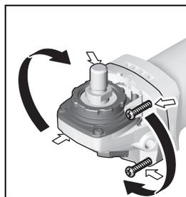
机器操作者可根据需要分段式转动机头，每一段的旋转角度为 90 度。此功能的优点是能够在特殊的工作状况下，把起停开关移动到比较容易操作的位置。例如切割时使用能够配合导轨板的吸尘罩 19，或者针对左撇子。
