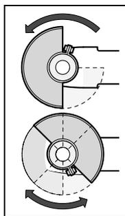
Montez le capot de protection 7 sur la broche d'entraînement. Adaptez la position du capot de protection 7 aux exigences des travaux à effectuer. Verrouillez le capot de protection 7 en serrant la vis de blocage 20 au moyen de la clé combinée 4.
