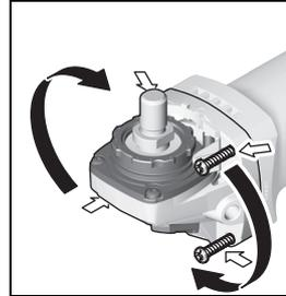
หัวเครื่องสามารถหมุนทำมุมกับตัวถังเครื่องได้เป็นขั้น ขั้นละ 90° ในลักษณะนี้สวิตซ์เปิด-ปิดสามารถเลื่อนไปอยู่ในตำแหน่งที่สะดวกต่อการใช้งานมากขึ้นเมื่อทำงานในสถานการณ์พิเศษ ต. ย. เช่น สำหรับการตัดที่ใช้แผ่นนำการตัด พร้อมฝาครอบดูดฝุ่น 19 หรือสำหรับผู้ถนัดมือซ้าย
