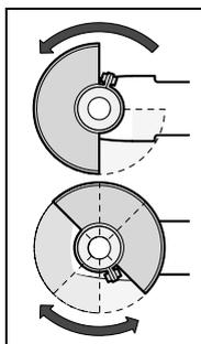
Lắp chấn bảo vệ 7 lên trên vòng cổ trục. Chính đặt vị trí của chấn bảo vệ 7 phù hợp với yêu cầu của công đoạn gia công. Khóa chấn bảo vệ 7 bằng cách siết chặt vít khóa chấn 20 bằng chia vận kết hợp 4.
