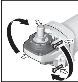
機器操作者可根據需要分段式轉動機頭，每一段的旋轉角度為 90 度。此功能的優點是能夠在特殊的工作狀況下，把起停開關移動到比較容易操作的位置。例如切割時使用能夠配合導引板的吸塵罩 19，或者針對左撇子。
