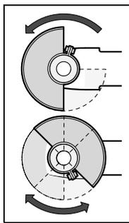
把防护罩 7 安装在主轴颈上。根据工作的需要调整好防护罩 7 的位置。固定好防护罩 7，此时要拧紧固定螺丝 20，拧紧时得借助通用扳手 4。
