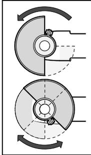
把防護罩 7 安裝在主軸頸上。根據工作的需要調整好防護罩 7 的位置。固定好防護罩 7，此時要擰緊固定螺絲 20，擰緊時得借助通用扳手 4。
