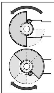
Pasangkan kap pelindung **7** pada poros kerja. Cocokkan kedudukan dari kap pelindung **7** dengan pekerjaan yang akan dilakukan. Kuncikan kap pelindung **7** dengan cara mengencangkan baut pengunci **20** dengan menggunakan kunci kombi **4**.
