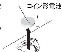
3. コイン形電池の+面を上にして、GCY42にコイン形電池を挿入します。
