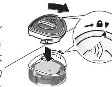
コイン形電池が挿入されていれば、電動工具のスイッチを入れると、GCY42は信号を送信し続けます。
