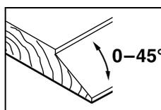
Para chanfrar dobraduras e superfícies, deverá ajustar o ângulo de chanfradura necessário com o ajuste angular **27**.
