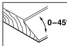
Khi xoi rãnh cạnh xiên và bề mặt, điều chỉnh độ dốc cần thiết bằng bộ phận điều chỉnh góc **27**.
