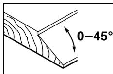
Para el cepillado inclinado de rebajes y superficies ajuste el ángulo de inclinación precisa- do con el ajuste angular **27**.
