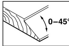
在凹槽或平面上刨斜边时，可以使用角度挡块 27 设定需要的斜角。
