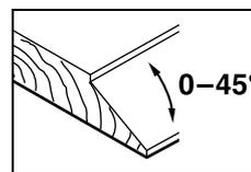
Pada waktu membuang pinggiran bertingkat dan pinggiran permukaan, setelkan sudut dengan menggunakan penyetelan sudut **27**.
