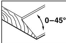
Pour chanfreiner des feuillures et des surfaces, réglez l'angle d'hélice nécessaire à l'aide du dispositif de réglage de l'angle **27**.
