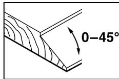
在凹槽或平面上刨斜邊時，可以使用角度擋塊 27 設定需要的斜角。
