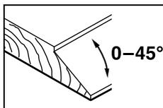
Para chanfrar ensabladuras e superfícies, deverá ajustar o ângulo de chanfradura necessário com o ajuste angular **27**.
