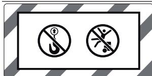
**N'accrochez pas l'aspirateur à un palan, un crochet de grue ou autre pour le transporter.** L'aspirateur n'est pas grutable. Il y a risque de blessure et d'endommagement.
