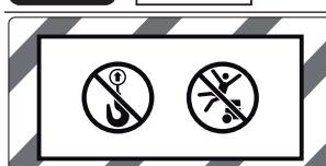
**Não pendure o aspirador, p. ex. para efeitos de transporte, num gancho de grua.** O aspirador não pode ser transportado por grua. Existe perigo de ferimentos e danos.
