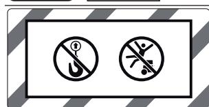
例如在运输途中切勿将吸尘器悬挂在吊车挂钩上。吸尘器不能用吊车吊运。有受伤和损坏的危险。
