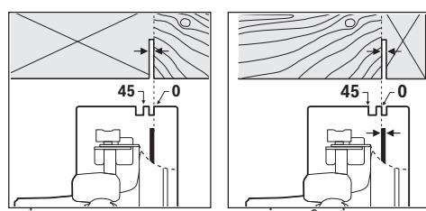
เครื่องหมายตัด 0° (10) และตำแหน่งของใบเลือยกองหาง การตัดเป็นมุมฉาก เครื่องหมายตัด 45° (9) และตำแหน่งของใบเลือยกองหางการตัด 45°
